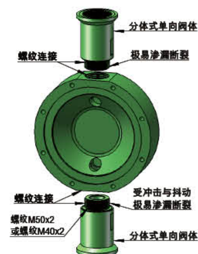
普通泵头 无需注塑模 (0成本) 持续承受压力 3Pa (3 公斤)
